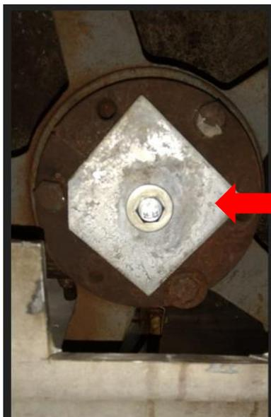
ACONDICIONAMIENTO PLATINA ATORNILLADA EN PERFORACION ROSCADA DEL EJE PARA ASEGURAR POLEA EN EL EJE DE LA DEPILADORA
