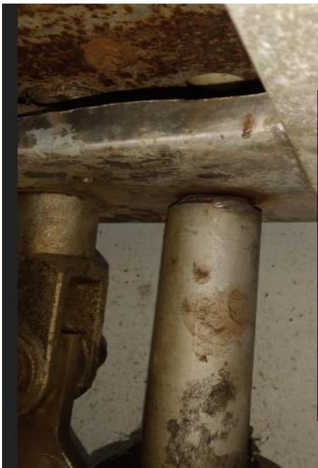
Se requiere programar una actividad a profundidad, ya que se debe desmontar todo el sistema, incluyendo el cilindro neumático del izado, se evalúa y se contemplan materiales necesarios para su reprogramación a coordinar
