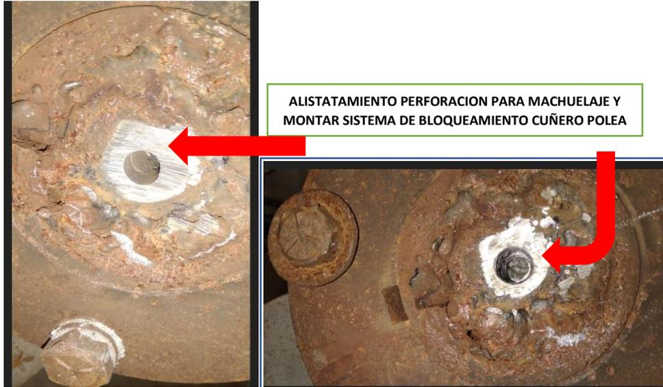
2. fabricar orificio central en la punta del eje donde esta ubicada la polea con el fin de acondicionar tope roscado y desmontable para mantener fija y alineada la polea
