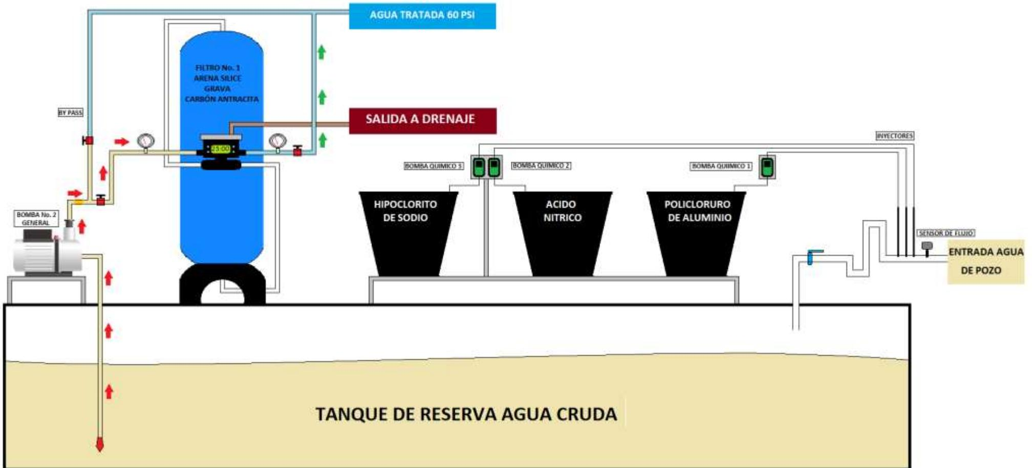
Podemos observar que el sistema extrae agua cruda del tanque de contacto mediante la bomba No. 2 y distribuye a servicio general posterior al paso del sistema de filtración.
