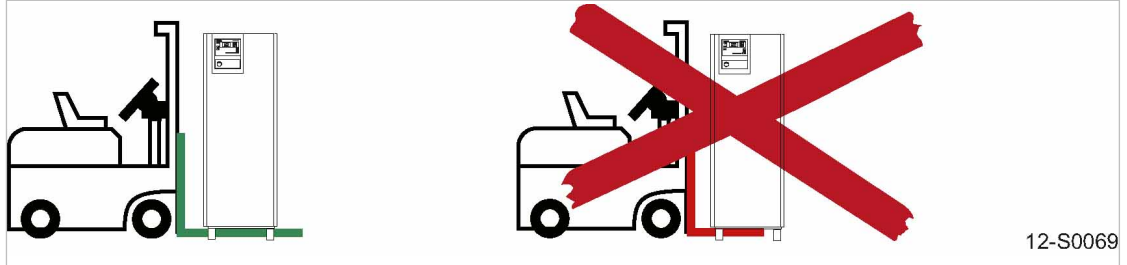
Fig. 33 Transporte con una carretilla elevadora
