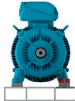
Figura 6.3 - Motor instalado sobre base metálica
