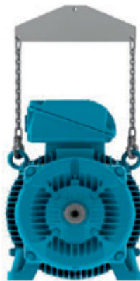
Figura 4.7 - Uso de barra separadora en la elevación
